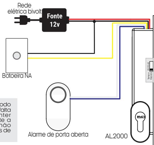
**ATENÇÃO:** Este modelo opera no modo "Fail Secure". Portanto, em caso de falta de energia, o pino irá se manter fechado. Recomenda-se fortemente a aplicação de nobreaks para não necessitar das chaves em situações de queda de energia.
