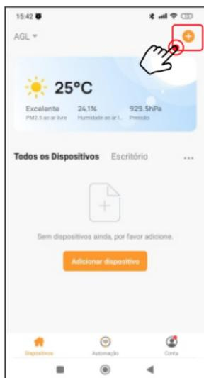
Certifique-se que o Painel de Led esteja em modo de pareamento (piscando). Caso não esteja, desligue e ligue novamente por 5 vezes em menos de 5 segundos. Este procedimento coloca o Painel de Led no modo de pareamento e ele começará a piscar.
